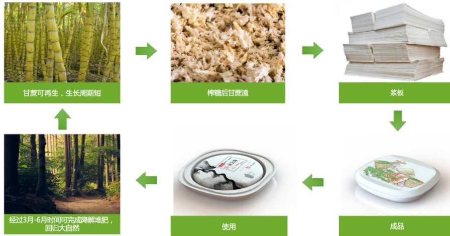
环保包装产品（茶叶包装）生产回收流程图
